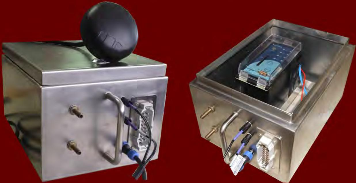
**El equipo AFOTRES-TS-GPRS permite, mediante espiras de inducción o tubos-gomas, realizar de un modo preciso el control del tráfico de vehículos en una vía, con discriminación de hasta cuatro carriles y determinación de sentido, velocidad, longitud e instante de paso de cada vehículo.**
