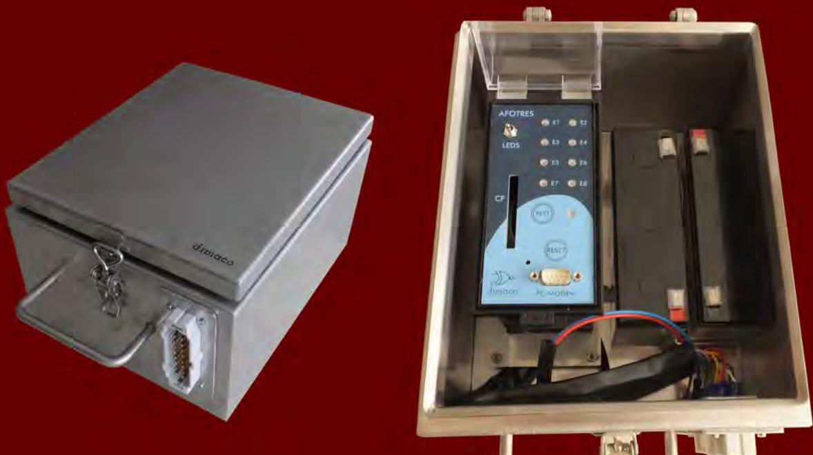
**El equipo AFOTRES-T permite mediante tubos de goma realizar de un modo preciso el control del tráfico de vehículos en una vía, con discriminación de hasta dos carriles y determinación de sentido, velocidad, longitud e instante de paso de cada vehículo.**
