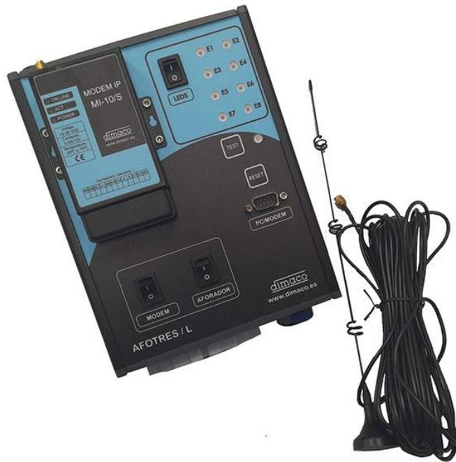
El equipo AFOTRES-L-GPRS permite, mediante espiras de inducción, realizar de un modo preciso el control del tráfico de vehículos en una vía, con discriminación de hasta cuatro carriles y determinación de sentido, velocidad, longitud e instante de paso de cada vehículo.
